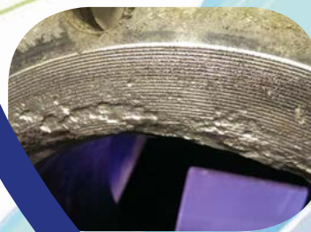
Réparation d'une fissure sur un réservoir d'huile hydraulique
